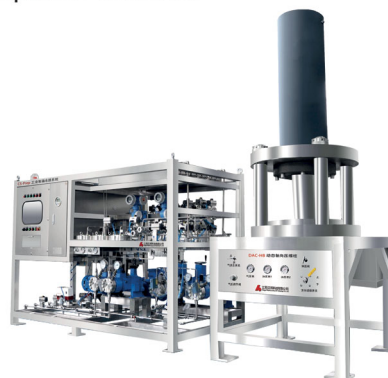
Препаративная HPLC промышленного масштаба: системы и колонны
